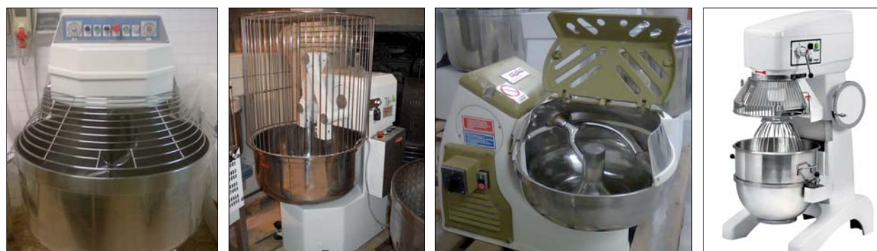
Diversi tipi di impastatrici: a) impastatrice a spirale; b) impastatrice a braccia tuffanti; c) impastatrice a forcella; d) impastatrice planetaria.
