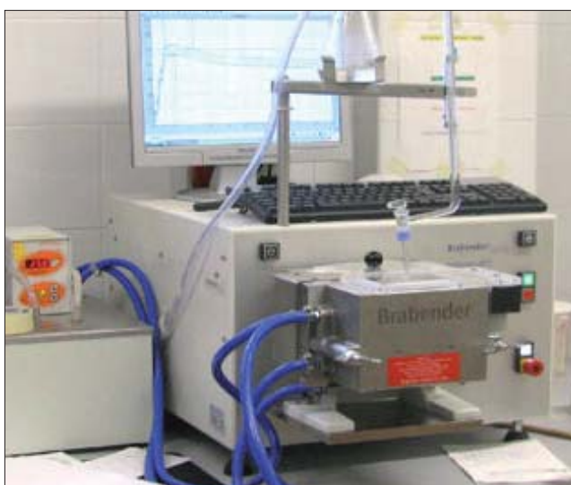
Farinografo di Brabender e esempio di farinogramma.
